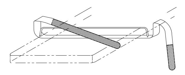
SLIDE THE RESTRAINT STRAP OVER THE END OF THE TABLETOP WITH THE SMALL RETAINING STRIP OVER THE TOP SURFACE OF THE TABLETOP.
