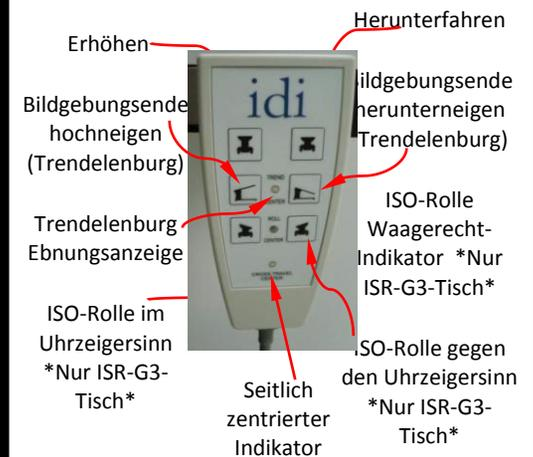
Es wird empfohlen, das Bediengerät bei kritischen Vorgängen zu trennen, um eine unerwünschte Bedienung oder Bewegung, die zu Verletzungen beim Patienten führen kann, zu verhindern. Die Bewegungssperre-Taste auf der Schwenkhebel-Einheit **deaktiviert die Handgerätesteuerung nicht.**
