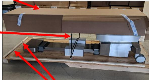
6. Entfernen Sie mit einem Ratschenschlüssel mit einem 9/16 " Innensechskantschlüssel zwei 3/8 " Schrauben vom Ende der Kippkufe, wie im Bild oben gezeigt.
