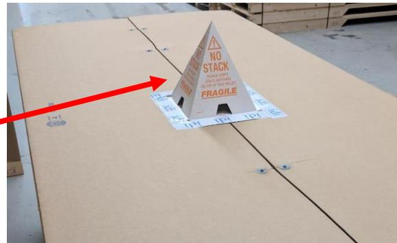
2. Mit der Kippkufe auf einer harten, glatten und ebenen Fläche; Verwenden Sie einen Kreuzschlitz-Schraubenzieher # 2 oder Bohrer, um alleschwarzen Schrauben um die Basis des Pappkartons zu entfernen, wie in der
