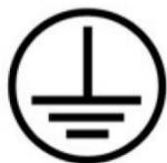
Masse de protection. Il s'agit du point de liaison commun entre la masse du câble d'alimentation électrique CA, la masse du cadre et la masse de l'unité de commande.
