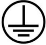
Conductor de protección. Este es el punto de unión común entre la conexión a tierra del cable de alimentación eléctrica de CA, la conexión a tierra del marco y la conexión a tierra del controlador.
