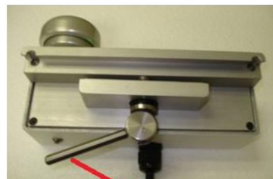
PALANCA PARA CONECTAR O SOLTAR EL MANGO AL RIEL ACCESORIO
