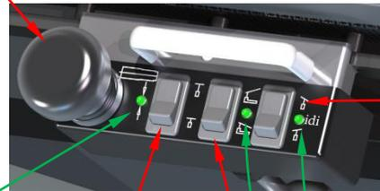
(La luz verde a la derecha del freno de flotación del tablero de la mesa indica que está centrado en la base de forma lateral)
