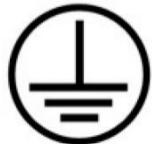
Schutzboden. Dies ist der gemeinsame Verbindungspunkt zwischen der Netzkabelmasse, der Rahmenmasse und der Controller-Masse.
