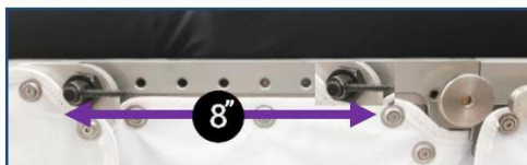
Le bouclier d'aile offre 8 pouces de blindage latéral supplémentaire.
