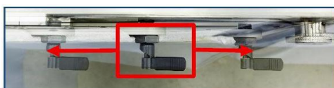
Lever noir central orienté vers les pieds PT pour glisser facilement dans les deux directions.
